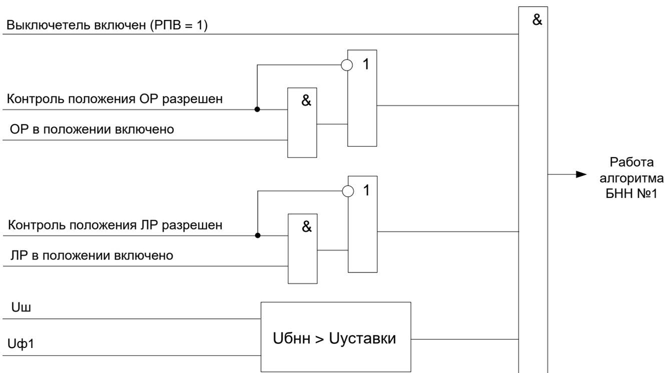
Рисунок 62 – Блок-схема первого алгоритма БНН
